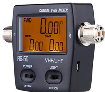
**Wattmètre-rosmètre digital à lecture directe.** Ici un RS-50, limité à 120W, BP de 125 à 525Mhz. La puissance incidente, la puissance réfléchie et le ROS (SWR) sont directement indiqués. Il fonctionne sur batterie interne.
