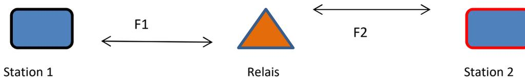
Ce que le relais reçoit sur la fréquence F1 est retransmis instantanément sur la fréquence F2 et inversement.
