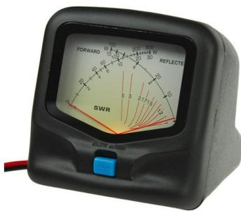
**wattmètre-rosmètre à aiguilles croisées.** Ici un RX-20, 2 calibres 30W et 300W, BP 1,8 à 200Mhz (HF et VHF), sans pile. Il existe le RX-40 qui couvre aussi l'UHF basse, 2 calibres de 15W et 150W.
